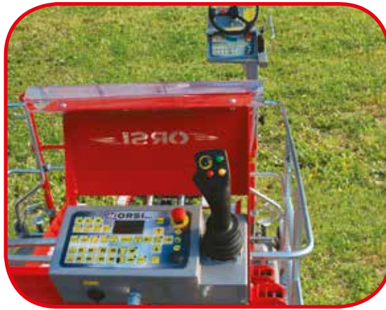
KIT RIPETIZIONE COMANDO DI GUIDA SU PIATTAFORMA POSTERIORE
