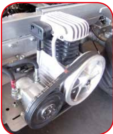
COMPRESSORE, FILTRO, 5 PRESE D'ARIA E 3 SERBATOI LT 23 CAD. CON SISTEMA AUTOMATICO ESSICAZIONE ARIA
