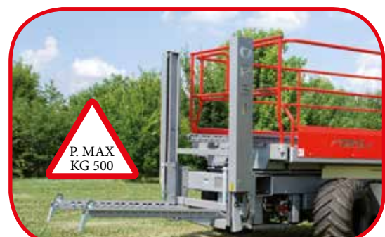
ELEVATORE ANTERIORE E POSTERIORE A COLONNA CON RULLIERE KG 230
