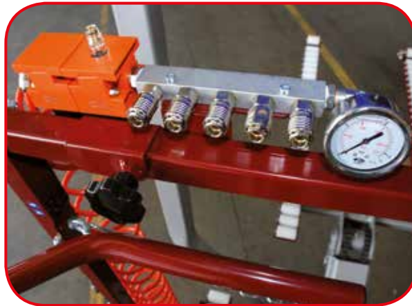
COMPRESSORE, FILTRO, 5 PRESE D'ARIA E DUE SERBATOI IT 23 CAD.(N.1MOD.2500) NO SU VERSIONE ECO + 3° BOMBOLE PER ESSICCAZIONE ARIA
