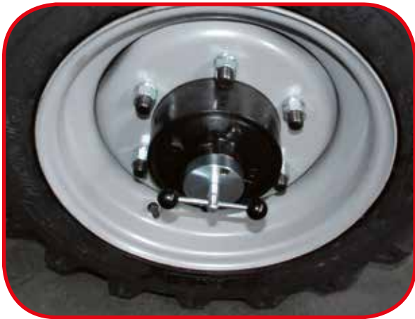
SBLOCCO RIDUTTORE RUOTA SULL'ASSALE POSTERIORE
